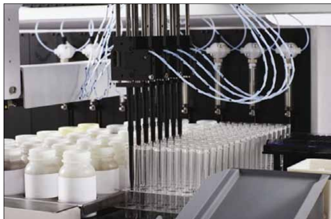
图4. OilPrep8油稀释装置, 配有8吸头的Varispan移液臂和1毫升的一次性吸头。
